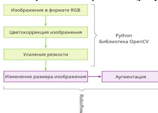
Рис. 1. - Схема предобработки снимков БЛА для детекции единиц лесного массива
