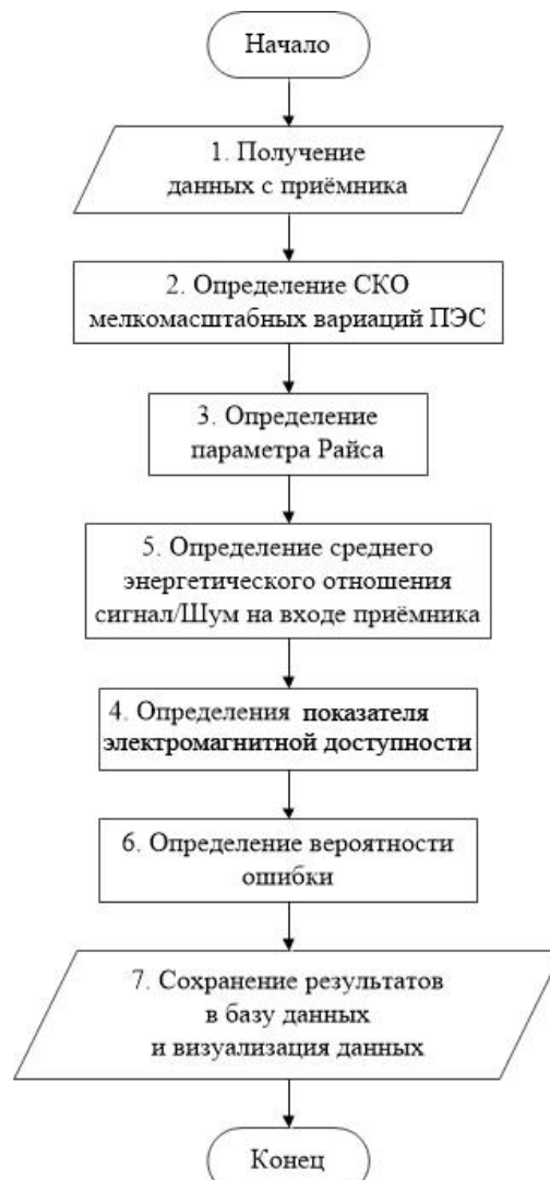
Рис. 2. – Алгоритм работы комплекса прогнозирования показателей электромагнитной доступности, с пониженной несущей частотой
