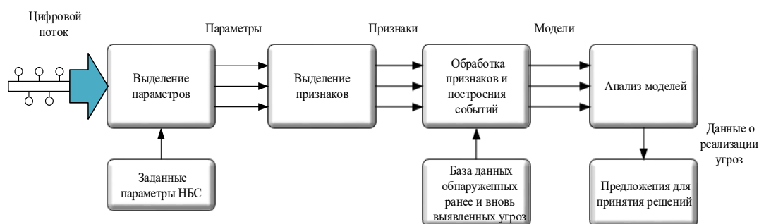
Рис. 1. - Структура процесса анализа служебного трафика при сетевом контроле
